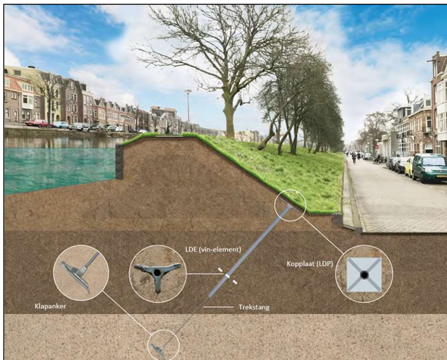
Figuur 1: visualisatie JLD-Dijkstabilisator in de Ringdijk
