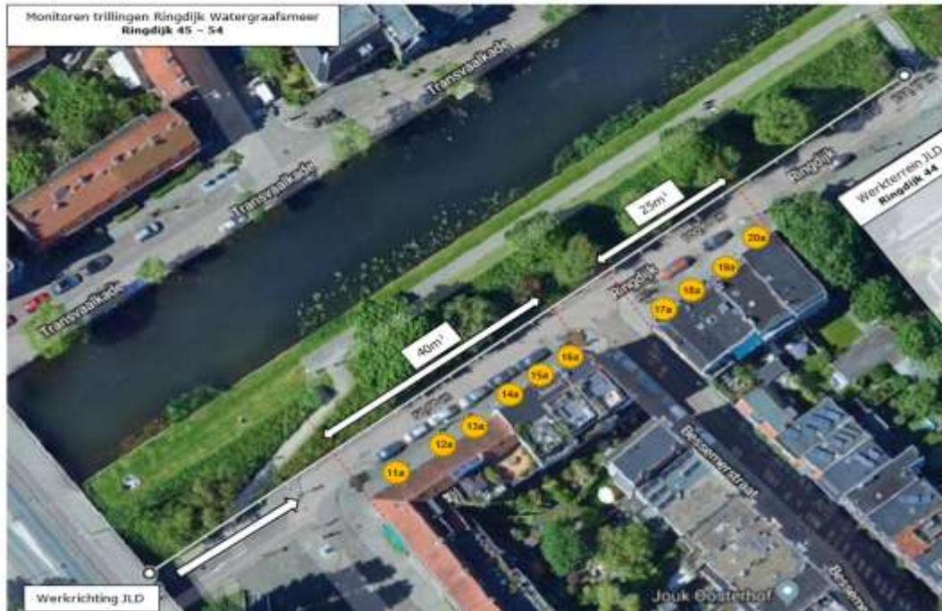
Figuur 12-3: Methode locatiebepaling van trillingsmeters. De gele cirkels zijn de locaties van de trillingsmeters.
