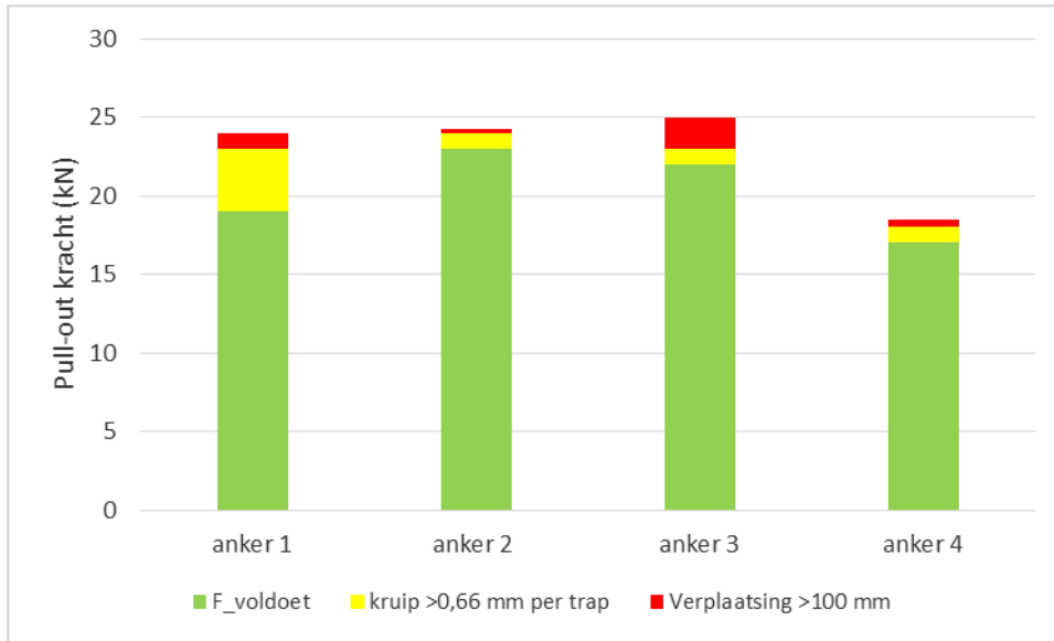
Figuur 5-10: Pull-out kracht per proef en bezwijkcriteria
