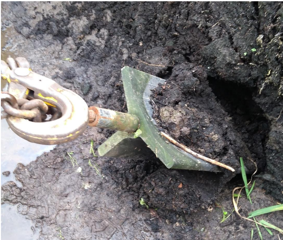
Figuur 5-11: Bezwijkmechanisme trekkraft van het LDE
