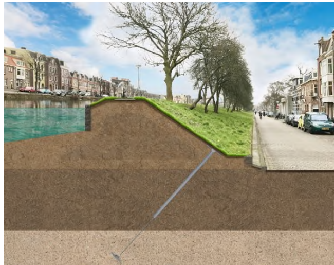
Foto 3-1; schematisatie van aan te brengen anker
