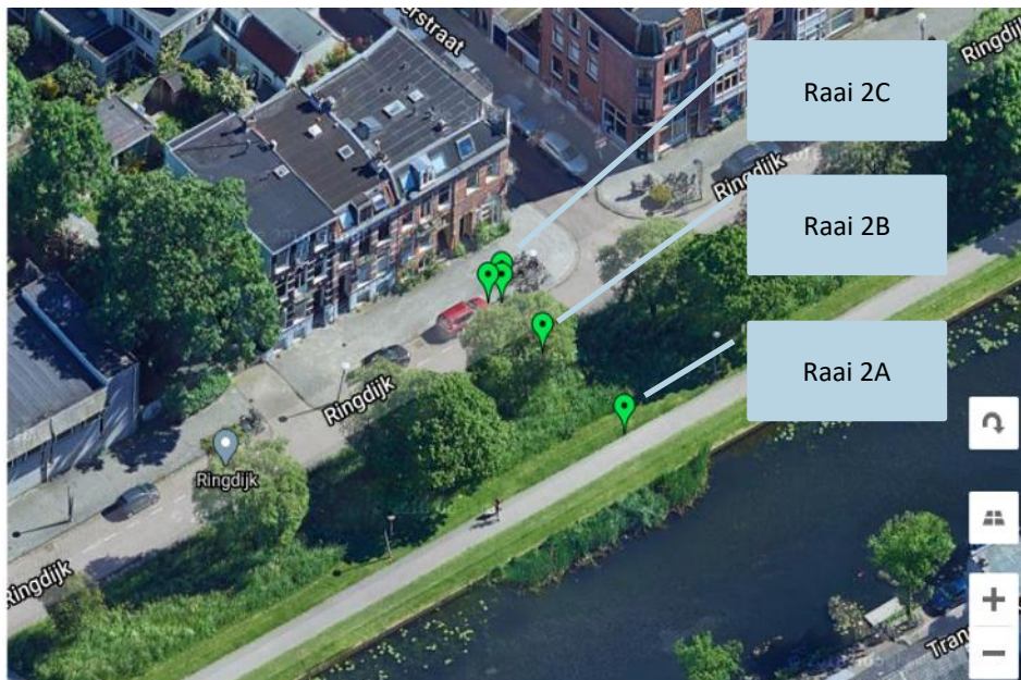
Figuur 4-3 Overzicht locatie peilbuizen en waterspanningsmeters raai 2
