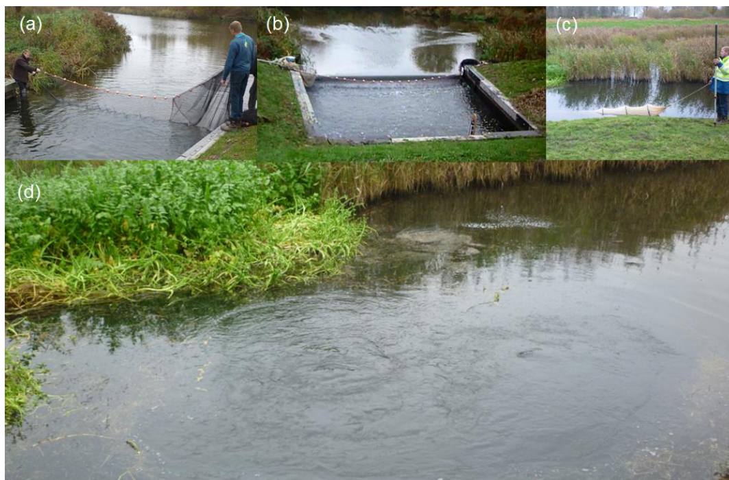
Figuur 3.53 Buisvijzel experiment op 17 november 2014: (a) plaatsen van het net achter de slibvang, (b) IJsselmeerwater wordt ingelaten, (c) en de vis wordt opgevangen met een fuik in de polder, (d) plaats waar het water –en de vis– de polder instroomt.
