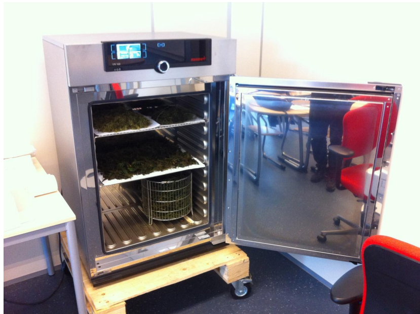
Figuur 5 Eerste lading voor droge stof meting ("Memmert 160" bij 110 graden voor 48 uur)
