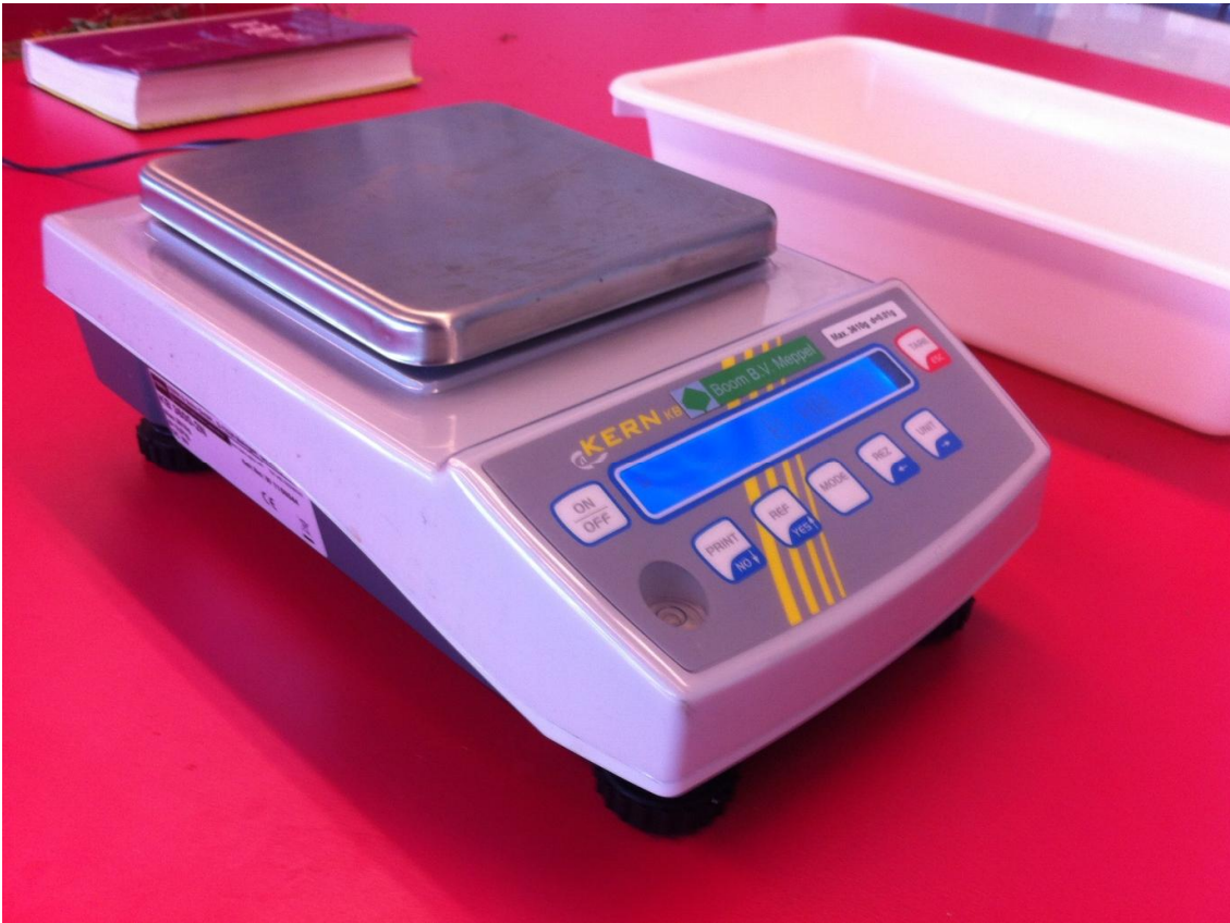
Figuur 6 KERN -KB 3600-2N weegschaal (max=3610 gram d=0,01 gram)
