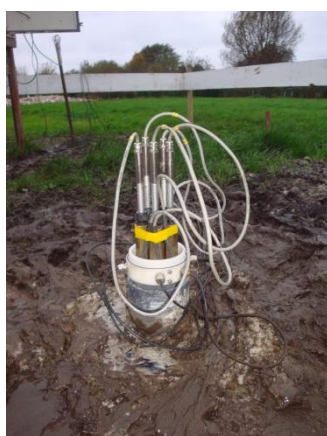
Figuur 3.2 Meetkop referentie extensometer
