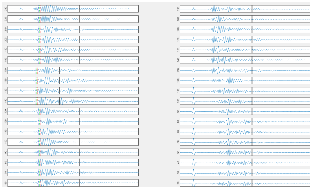
Figuur 20 Weergave van de signalen met de dikte van de betreffende hoogte van de paal; de grijze dikke lijn is de dikte-indicatie (niet naar schaal). In drie kleuren zijn drie verwachte reflectie-momenten aangegeven in de signalen
