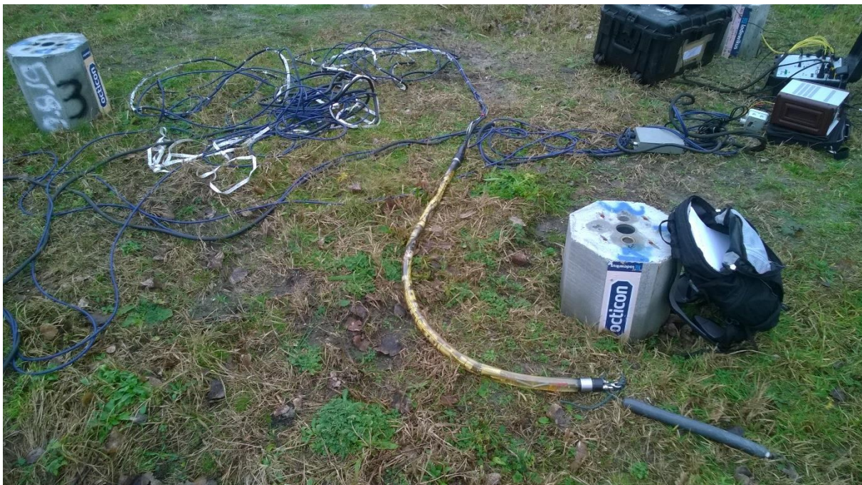
Figuur 1 Meetopstelling met de Seismic Tube; rechts boven de aansturing.
