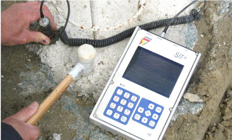
Figuur 16 Een PIT systeem met ontvanger en hamer bij een in-situ funderingspaal (Hektec, 2019)
