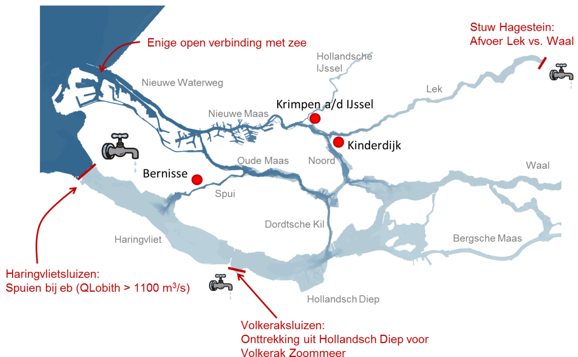
Figuur 1.1 Overzichtsk kaart Rijn-Maasmonding. De belangrijkste stuurknoppen van het hoofdwatersysteem zijn aangegeven met een kraantje. Met rode stippen zijn een drietal locaties aangegeven die belangrijk voor zoutverspreiding. In blauwschakeringen de saliniteit (hoe donkerder hoe zouter) uit een 3D modelberekening van het najaar 2011, waarbij zout via de noordrand de zuidrand kon bereiken (achterwaartse verzilting).
