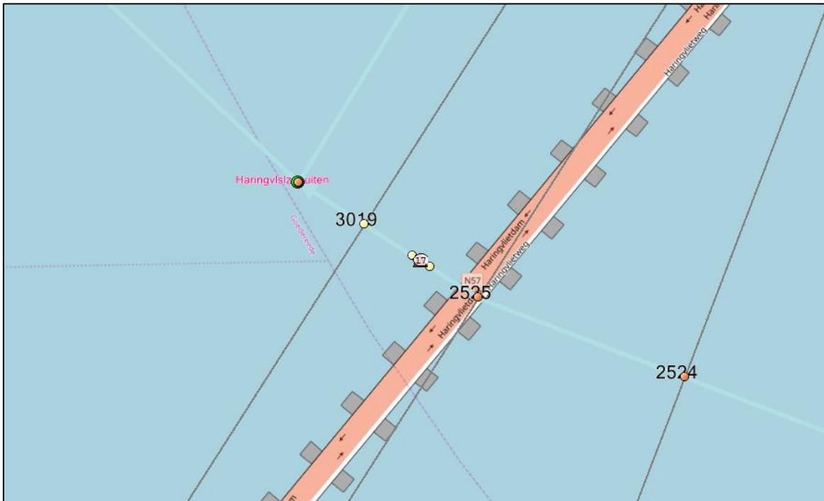
Figuur 4.3 Detailfiguur van de takkenstructuur, de locatie van de Haringvlietssluis (cirkel met 17) en de rekenpunten (geel) in de oorspronkelijke situatie (boven) en in de aangepaste situatie voor het SOBEK 3 RMM model (onder).
