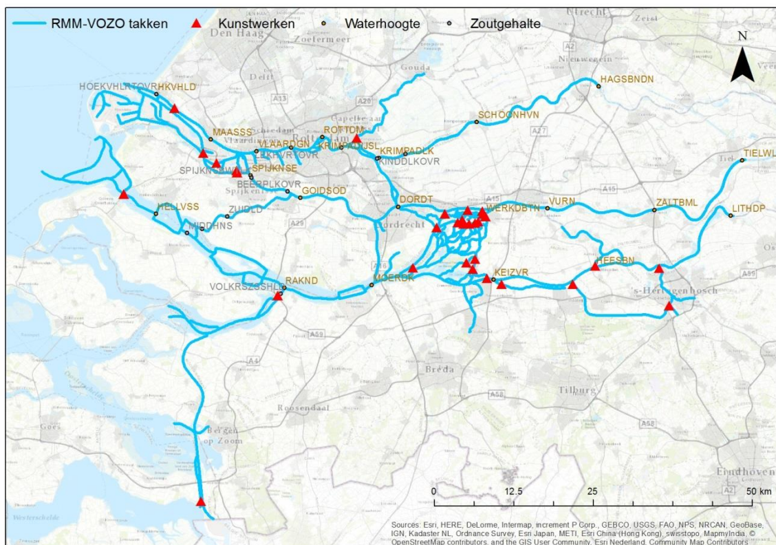
Figuur 4.1 Overzicht van de takkenstructuur van het SOBEK 3 RMM model met aanduiding van kunstwerken, waterstandsmeetstations en zoutmeetstations
