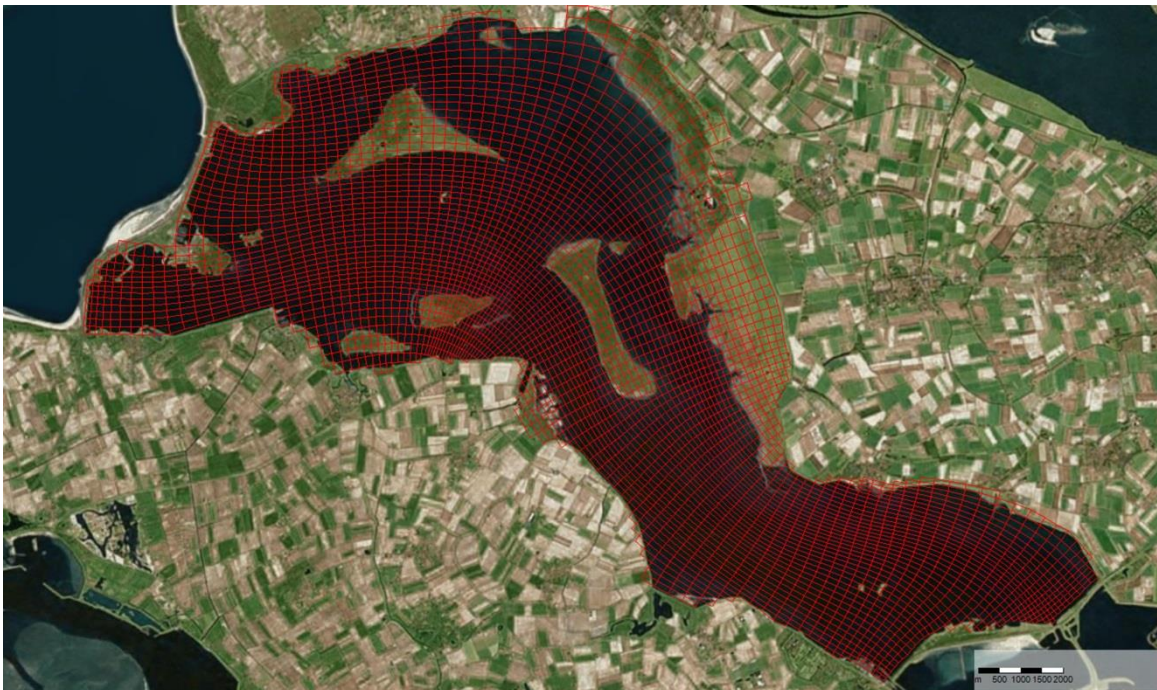
Figuur 6.3 Originele curvi-lineaire Delft3D-rooster.
