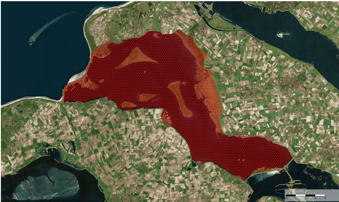
Figuur 6.6 Regelmatig driehoekige rooster met zijanten van 190 m.
