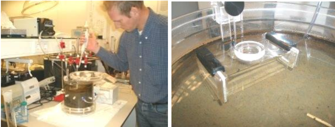
Figuur 2.4 Links: SOFIE-meetcel met ongestoorde sedimentkolom. Rechts: doorstroomcel met reactief sorptiemiddel Chelex. De bovenstaande waterschijf werd gedurende 30 minuten (drie maal het volume van de waterschijf) door de doorstroomcel geleid en zo ontdaan van de labiele metaalfractie.
