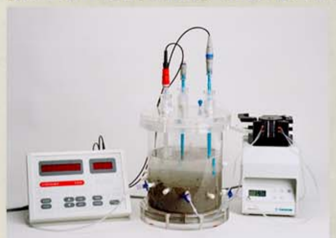
• Jos Vink's meetopstelling. In de luchtdichte meetcel (midden) zit baggerspecie. Het poriewater daaruit wordt eerst naar een filter geleid (rechts) dat de vrije zware metalen wegvangt. Metaalzouten en organisch gebonden stoffen passeren de filterkolom wel, en zo worden de metalen gesplitst in een schadelijk en een onschadelijk deel. FOTO JOS VINK
