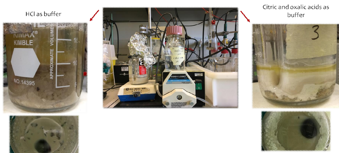
Figure 3.2 Titratie opstelling voor het bepalen van de hoeveelheid zuur die nodig was om het asbestcement af te breken. Links: HCl; rechts: citroenzuur/oxaalzuur.
