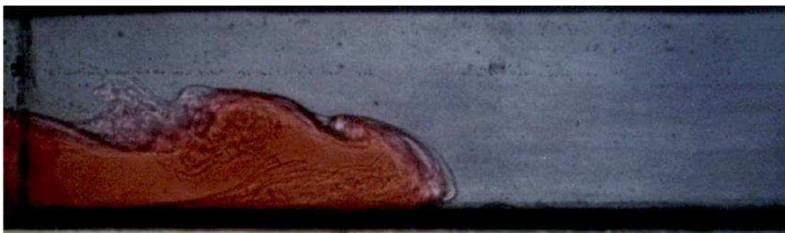
Figuur 2: Dichtheidsgedreven uitwisselingsstroming met het zwaardere zoute water in rood (Deltares, Voorstudie: Ontwerpstudie en Praktijkproef Zoutlekbeperking Volkeraksluizen, 2010)
