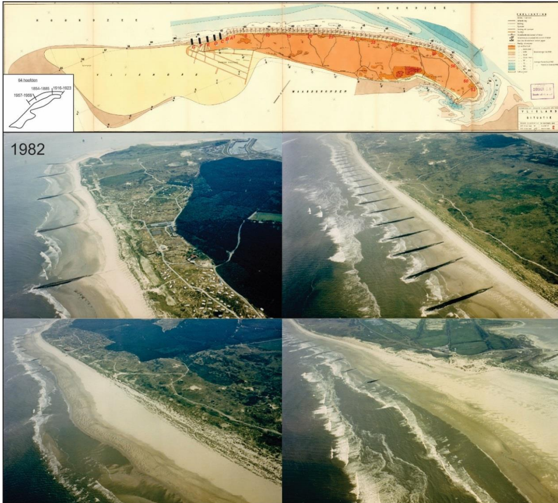
Figuur 8: Boven: ligging van de strekdammen aan de hand van een kaart uit Visser (1946). Onder: Impressie van de strekdammen van Vlieland nabij de NO punt (linksboven en -onder), centrale eilandkust (rechtsboven) en overgang naar de Vliehors (rechtsonder). Foto's: https://beeldbank.rws.nl , Rijkswaterstaat.
