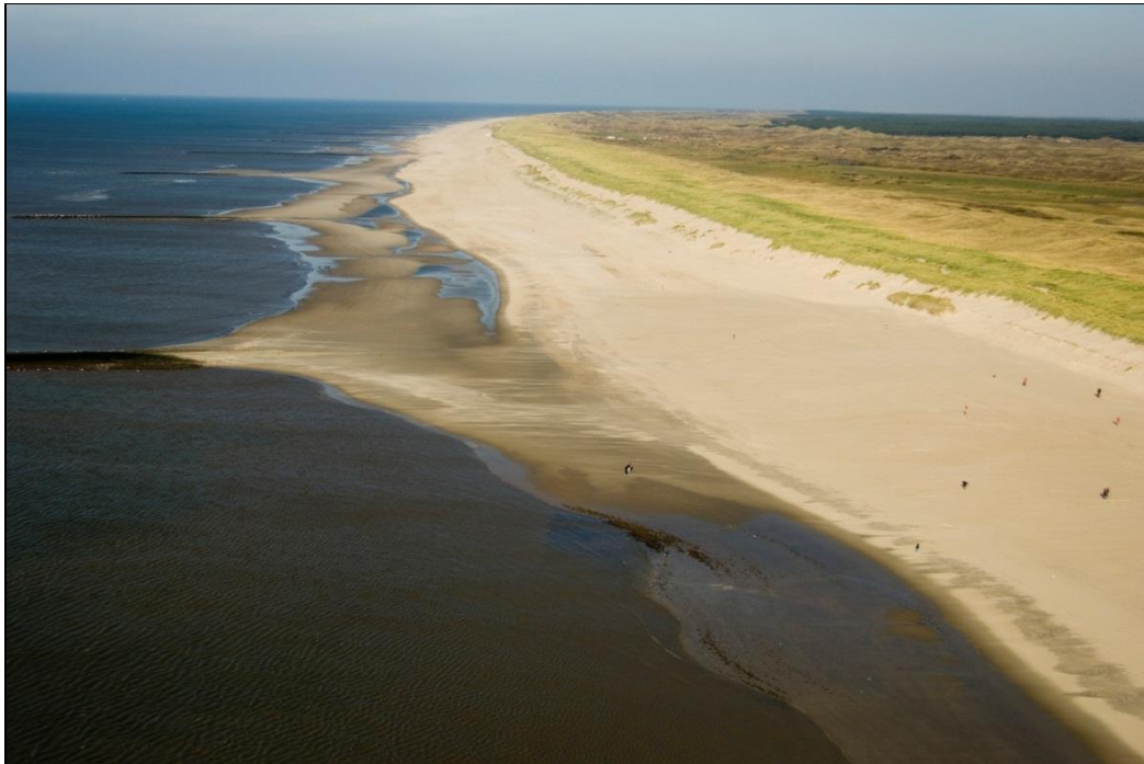
Figuur 5: Strandhoofden langs de zuidwestkust van Texel (ter hoogte van Den Hoorn). Bron: http://beeldbank.rws.nl .
