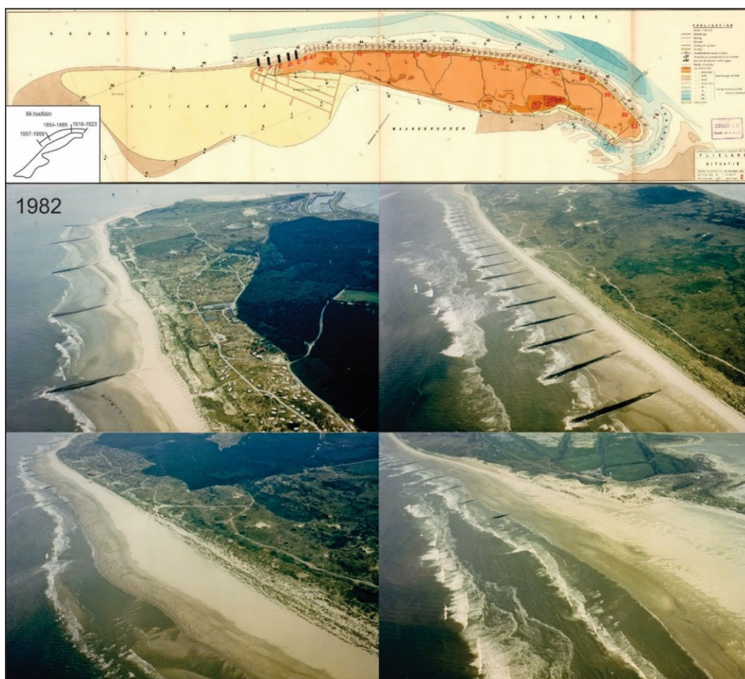
Figuur 2-2: Boven: ligging van de strekdammen aan de hand van een kaart uit Visser (1946). Onder: Impressie van de strandhoofden van Vlieland nabij de NO punt (linksboven en -onder), centrale eilandkust (rechtsboven) en overgang naar de Vliehors (rechtsonder). Foto's: https://beeldbank.rws.nl , Rijkswaterstaat.
