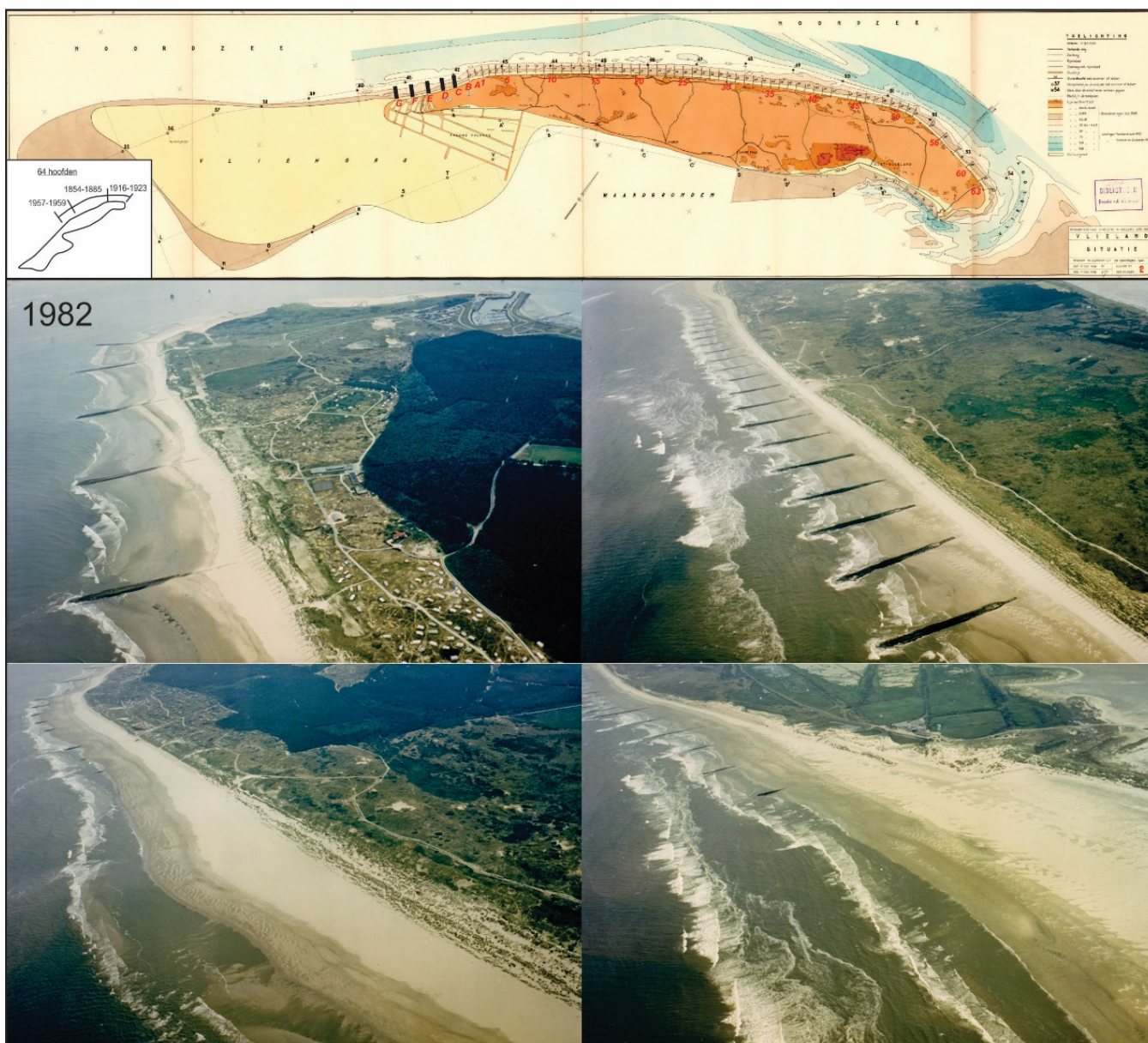
Figuur 2-2: Boven: ligging van de strekdammen aan de hand van een kaart uit Visser (1946), met toegevoegd locatie hoofden C-F. Onder: Impressie van de strekdammen van Vlieland nabij de NO punt (linksboven en -onder), centrale eilandkust (rechtsboven) en overgang naar de Vliehors (rechtsonder). Foto's: https://beeldbank.rws.nl , Rijkswaterstaat.
