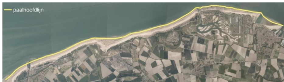
Figuur 2-1. Lijn die de zeewaartse grens van de paalhoofden verbindt. Deze lijn is tevens de gekozen zeewaartse grens van het strand voor de volumebepaling. De achtergrond is de PDOK Luchtfoto 2020 Ortho 25 cm RGB.
