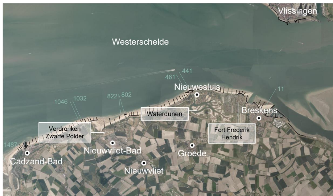
Figuur 3-2. Overzicht van de Zeeuws-Vlaamse kust (PDOK luchtfoto 2020). De zwarte lijnen geven de steenzettingen (palenrijen, strekdammen en andere harde elementen) weer.
