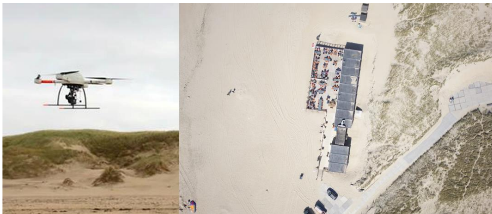
Figuur 2.1: Links:gebruikte UAV voor de monitoring: MD4-1000. Rechts: een deel van de orthophoto van de T1 rond een strandpaviljoen bij Julianadorp
