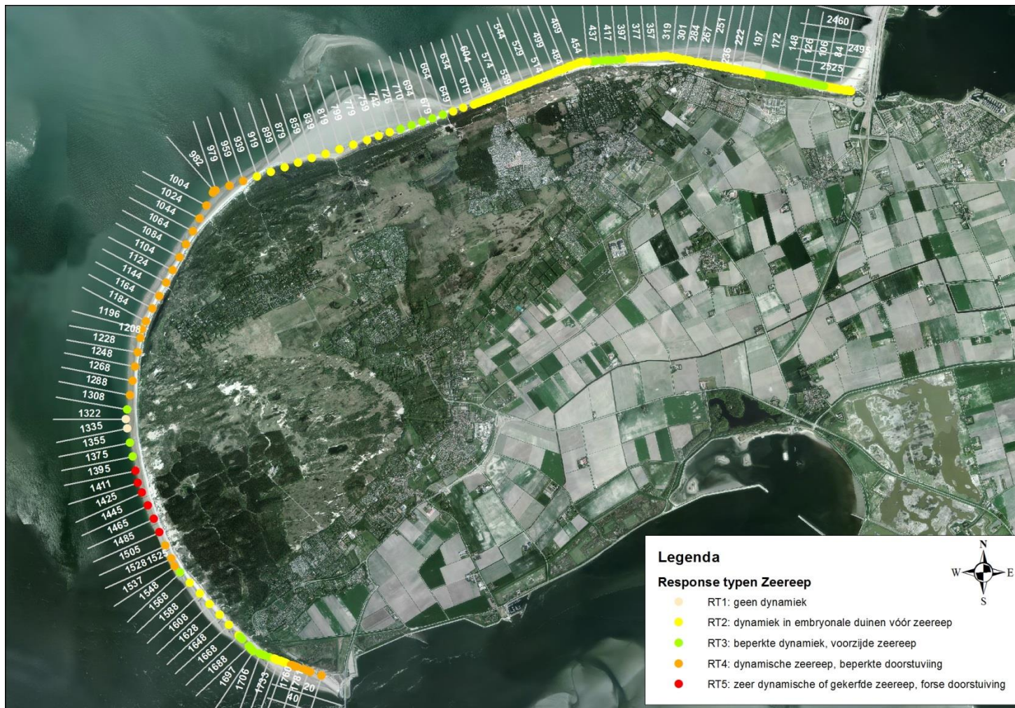
Figuur 4.74 Classificatie van de zeereep voor Schouwen. Het betreft de huidige classificatie van responstypen zoals ze nu (2012) gelden, gebaseerd op laseraltimetrie 1997/1998-2012 en luchtfoto's 2011 en 2012.
