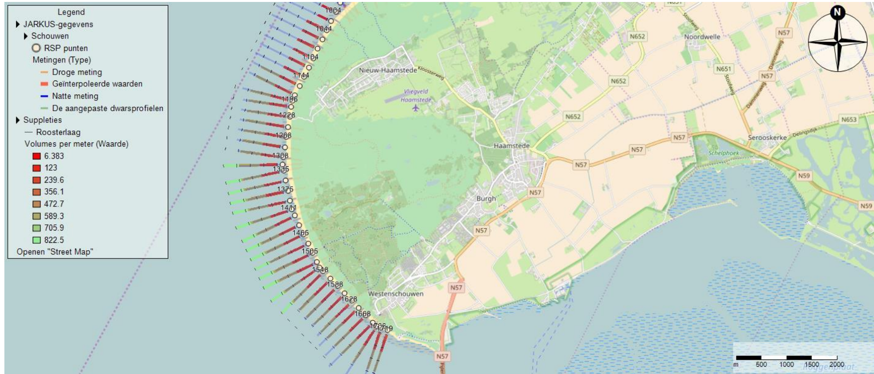
Figuur 4.35 Locaties van Jarkus raaien 1004-1548 en 1548-1800 met suppletievolumes in deelgebieden III en IV (achtergrondkaart: OpenStreetMap).
