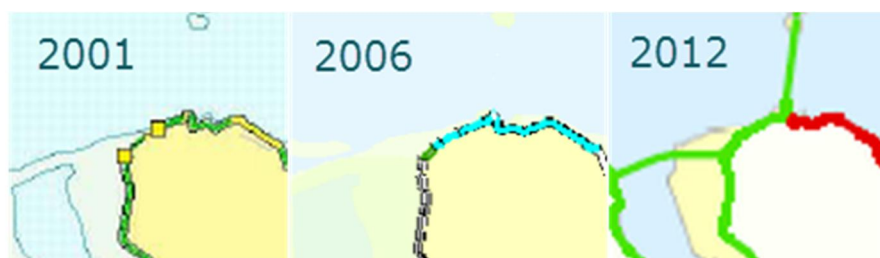
Figuur 5.11 Toetsresultaten primaire waterkering in de 1 e (2001), 2 e (2006) en 3 e (2012) toetsronde. Groen betekent goedgekeurd, geel of blauw geen oordeel of afgekeurd. Bij de laatste toetsronde is de gehele kering langs de Noordzeekust goedgekeurd.
