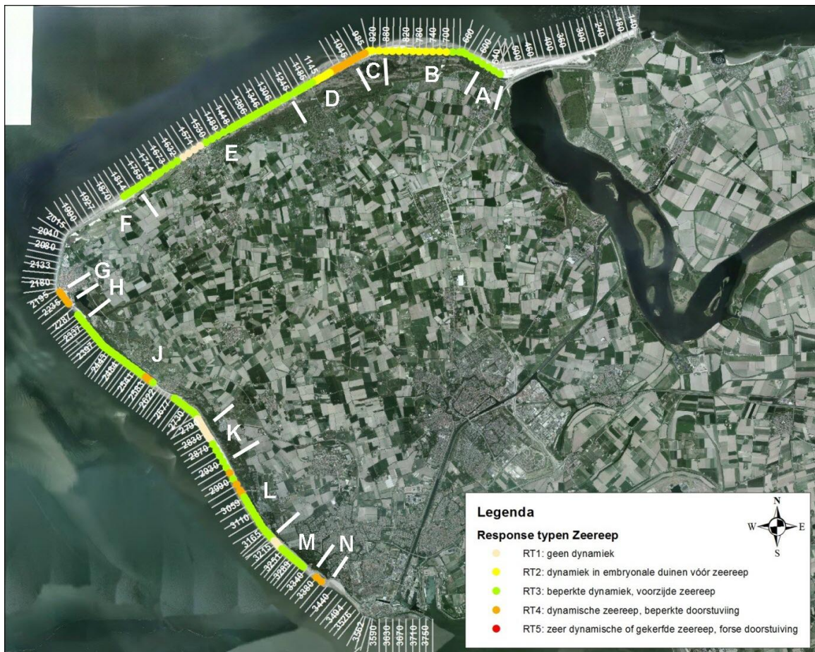
Figuur E.1 Classificatie van de zeereep voor Walcheren. Het betreft de huidige classificatie van responstypen zoals ze nu (2012) gelden, gebaseerd op laseraltimetrie 1997/1998-2012 en luchtfoto's 2011 en 2012.
