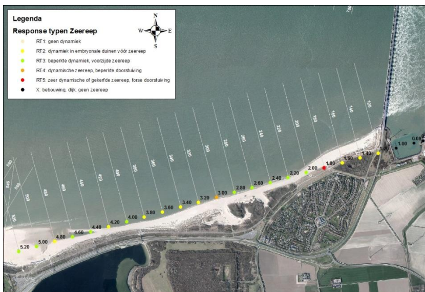
Figuur E.2 Classificatie van de zeereep voor Noord-Beveland. Het betreft de huidige classificatie van responstypen zoals ze in 2014 gelden, gebaseerd op laseraltimetrie 1997/1998-2014 en luchtfoto's 2014.
