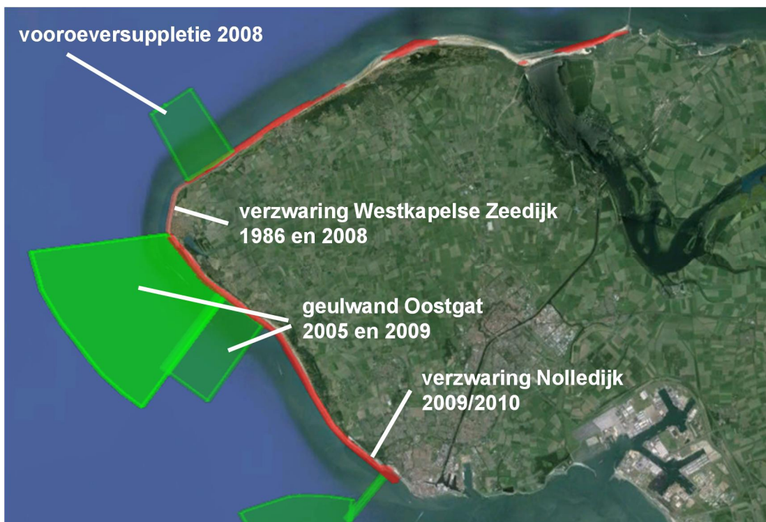
Figuur 4.1 Overzichtskaart met uitgevoerde suppleties tot 2012, rode vlakken zijn strandsuppleties, duin- en dijkverzwaringen, groene vlakken zijn onderwatersuppleties. De belangrijkste ingrepen zijn extra aangeduid. (Vermaas en Bruens, 2013).
