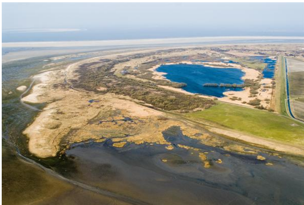
Figuur 5.2 Westerplas kijkend naar het noorden: Rechts is de oorspronkelijke dijk van de Banck nog zichtbaar, zuidelijk ervan bedekt de Waterstaatsdijk deze dijk en gaat naar het westen (links) over in een stuifdijk. Foto 2007; https://beeldbank.rws.nl , Rijkswaterstaat / Joop van Houdt
