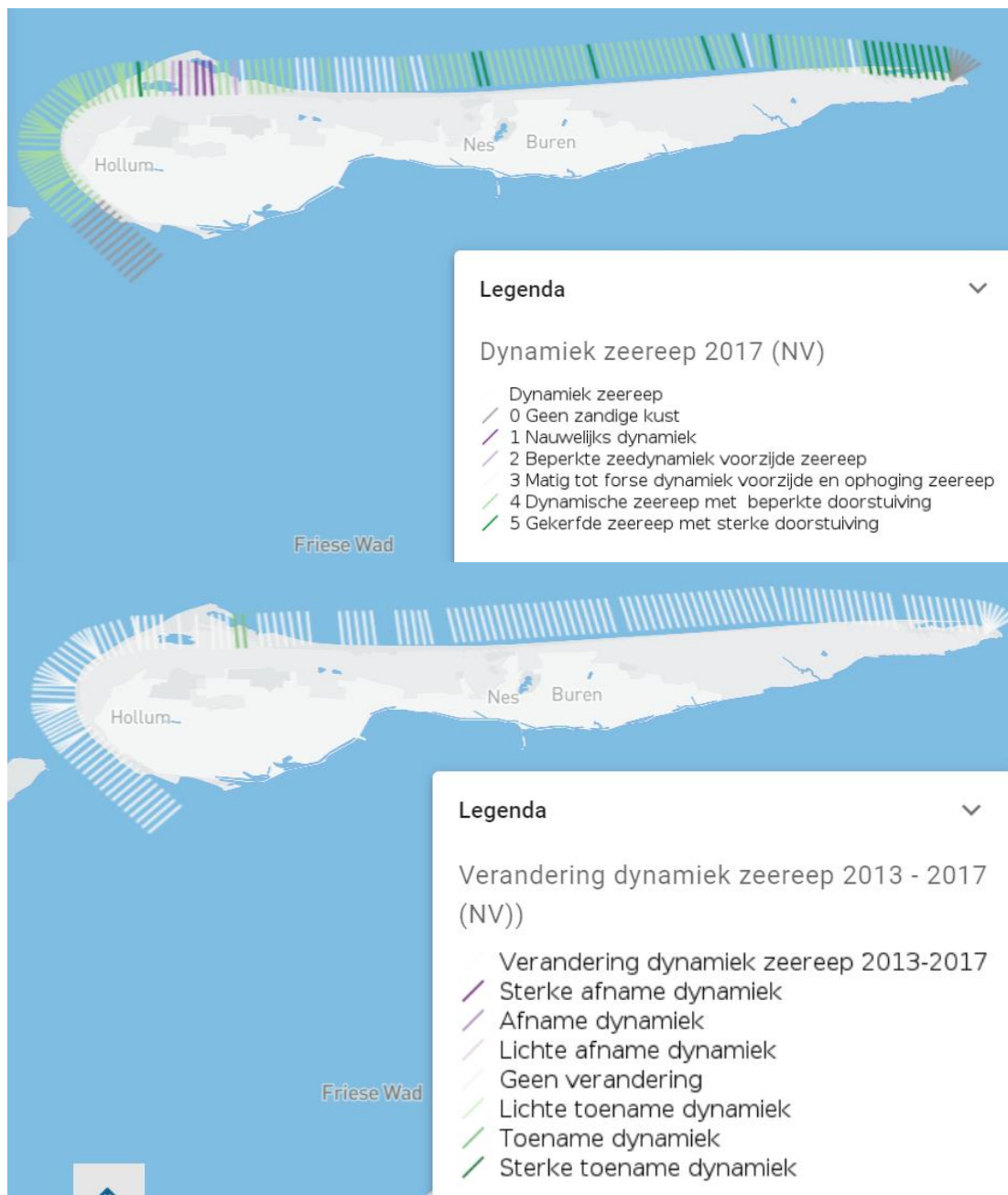
Figuur 6-15: Dynamiek van de zeereep in 2017 (boven) en veranderingen in de dynamiek van de zeereep 2017 ten opzichte van 2013 (onder). Bron: natuurlijkveilig.nl
