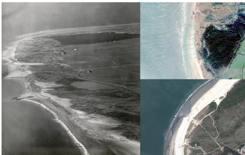
Figuur 4-1: Kustverdediging Ameland. Links: Strandhoofden beschermen de eilandkop ter plaatse van het Borndiep in 1954 ( https://beeldbank.rws.nl , Rijkswaterstaat). Rechtsboven: kustverdediging Ameland-West (satellietdataportaal eind 2022, de blauwe vierkanten geven de ligging van de strandhoofden weer) en uitvoering van een suppletie op de eilandkust in 2019 (satellietdataportaal 2019).
