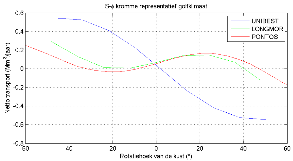
Figuur 2.10 S- \Phi kromme op basis van het representatief golfklimaat.
