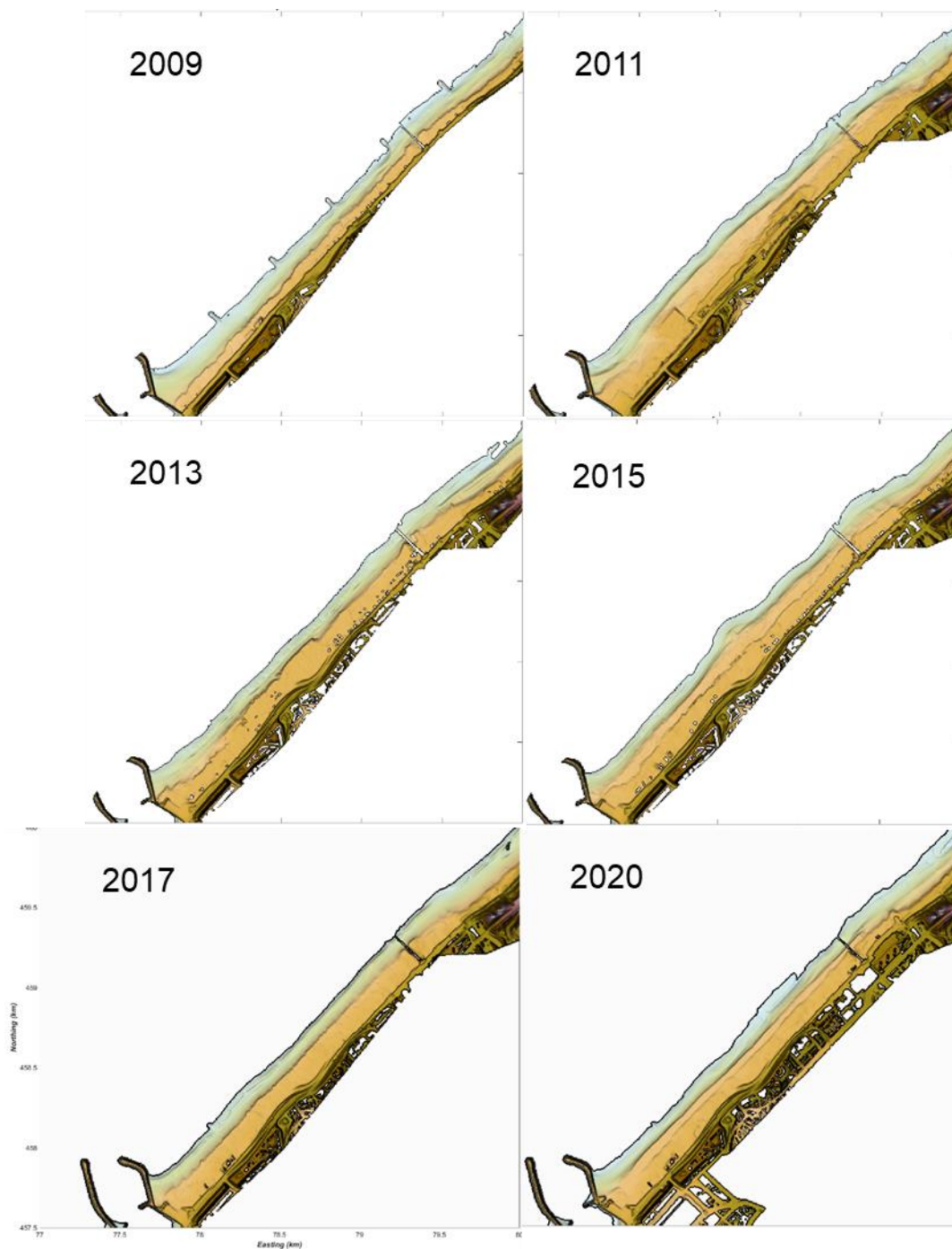
Figuur A- 2 Bodemhoogte van het strand en duin op basis van de Lidarmetingen, voor jaren 2009, 2011, 2013, 2015, 2017 en 2020.
