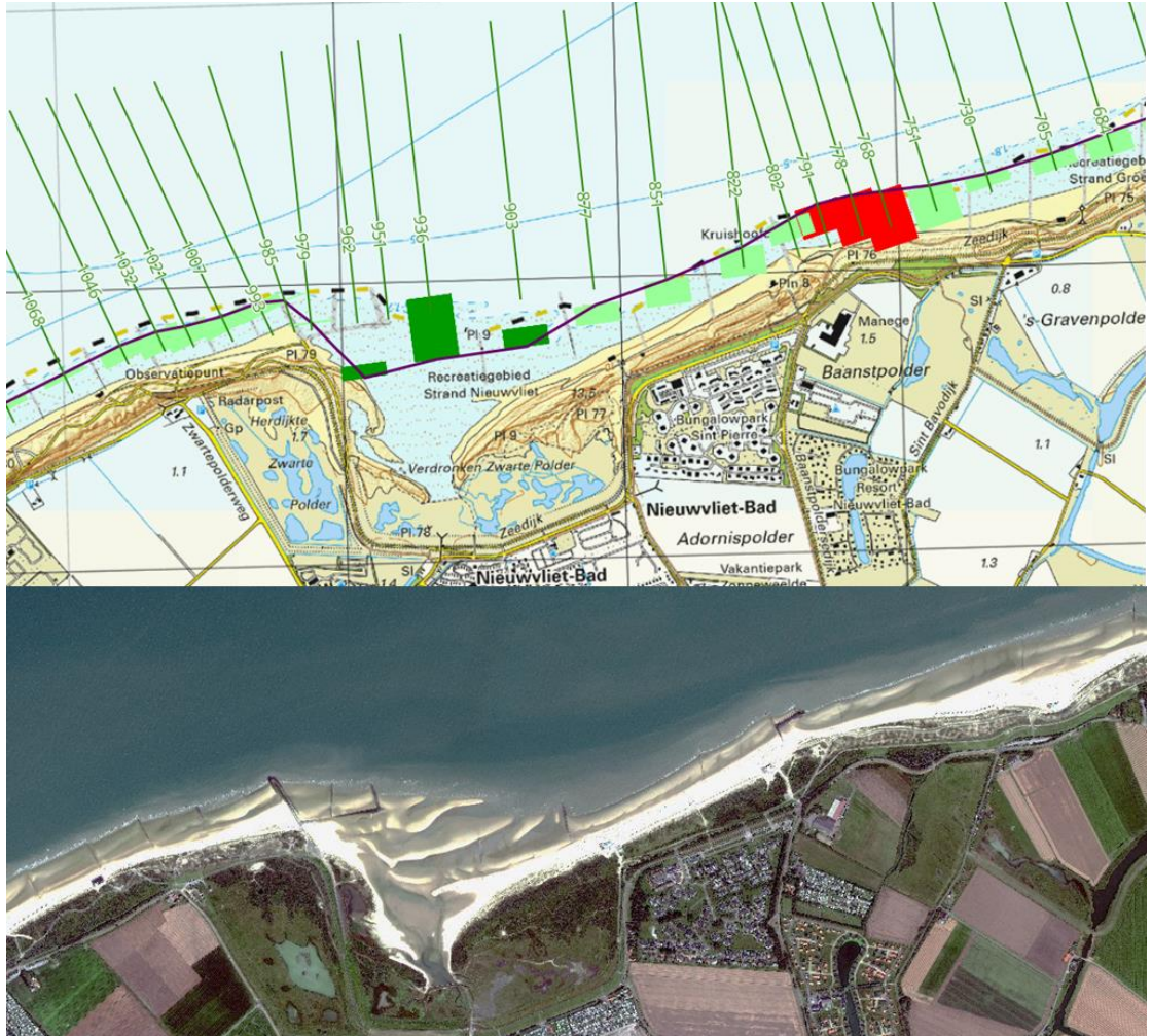
Figuur 5-2 ; Overzicht van de probleemlocatie Nieuwvliet-Groede met daarin de resultaten van de toetsing van de kustlijn (2021). Bij het Kruishoofd ligt de TKL landwaarts van de BKL en is de trend negatief. Onder: een overzicht van ligging van het droogvallende strand, duinen en harde verdedigingswerken aan de hand van een satellietopname van 11-08-2021.
