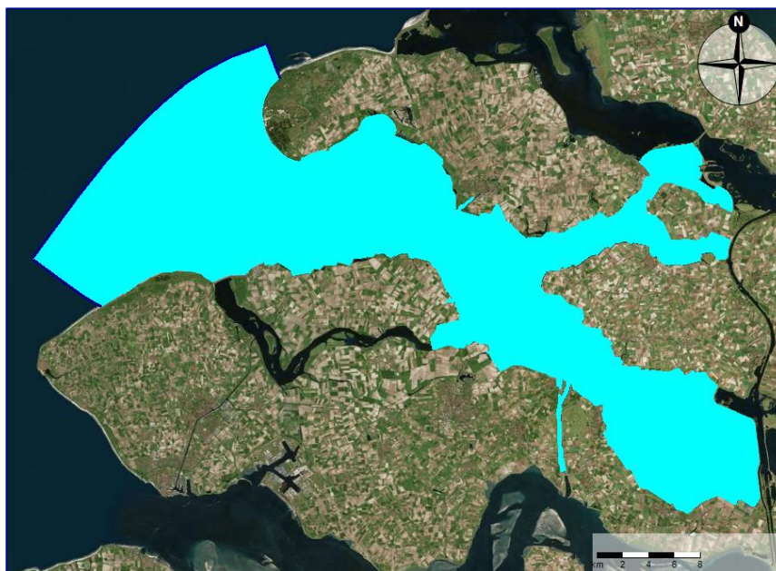
Figuur 3-1 Modeldomein van het Oosterschelde estuarium. De donkerblauwe rand aan de westkant van het model is de modelrand waar randvoorwaarden zijn toegepast.
