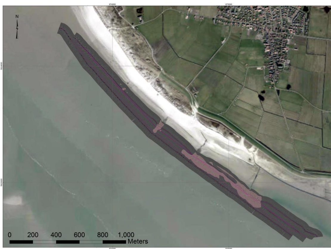
Figuur 4.1 Overzicht van gevaren side-scan sonar lijnen. In het roze zijn de gebieden waar stort is geïnterpreteerd
