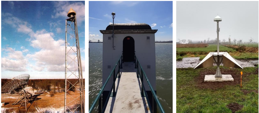
Figuur 2.1: Verschillende mogelijke monumenten. Van links naar rechts: stalen mast (Terschelling), RVS paal (Hoek van Holland), IGRS (Zegveld).
