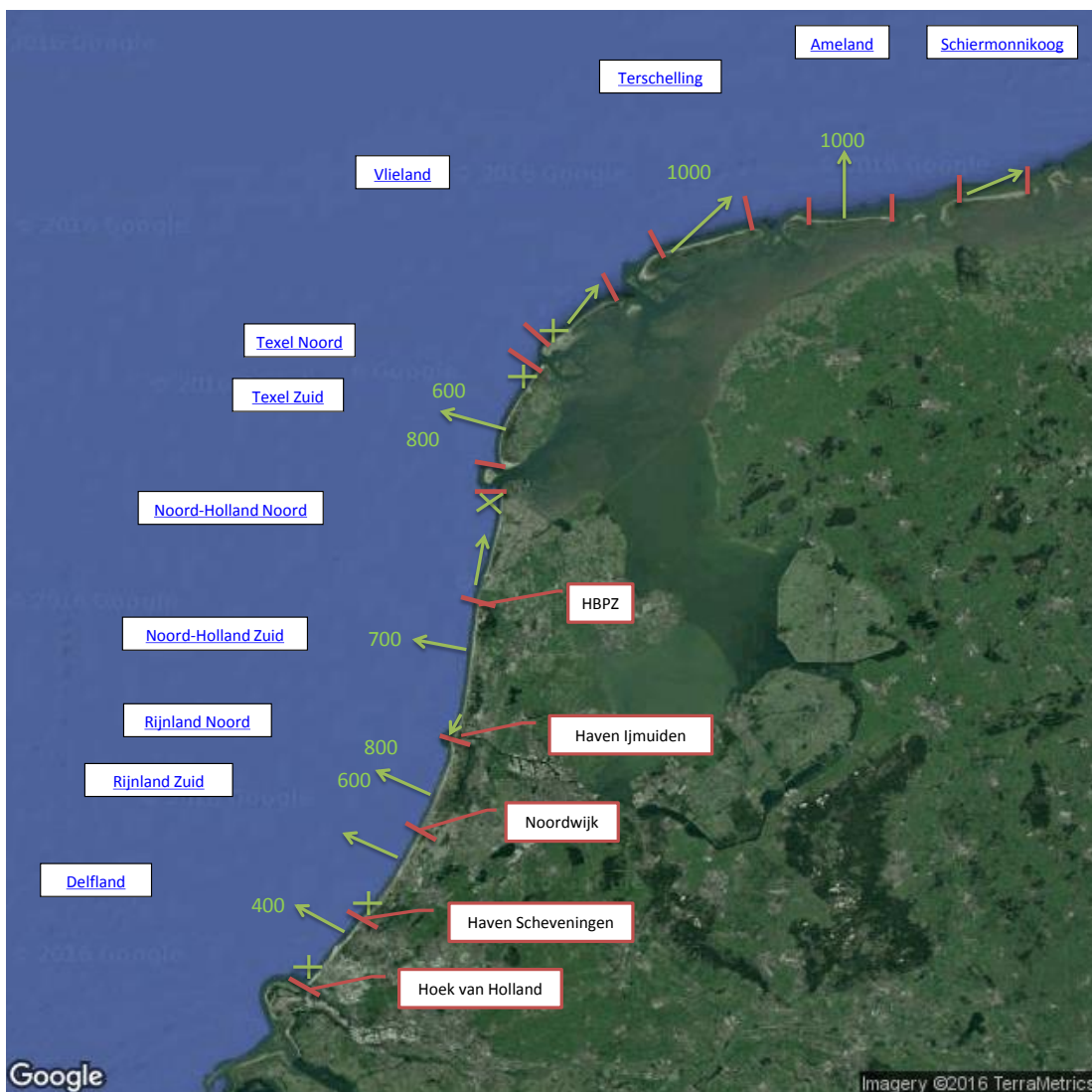
Figuur 8: Overzicht bankgedrag langs de Nederlandse kust. Met de getallen is, in het geval een 'zone of decay' aanwezig is, de positie aangegeven
