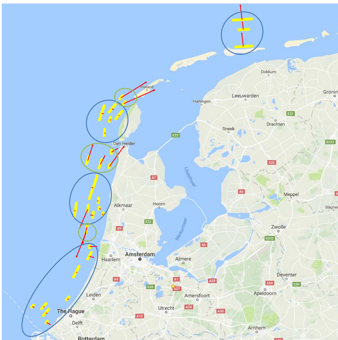
Figuur 10: Overzicht groeperingen van vooroeversuppleties langs de Nederlandse kust. De vooroeversuppleties met een blauwe omkadering migreren richting de 'zone of decay'. De vooroeversuppleties met een groene omkadering bewegen vooral langs de kust en naar de kust toe.
