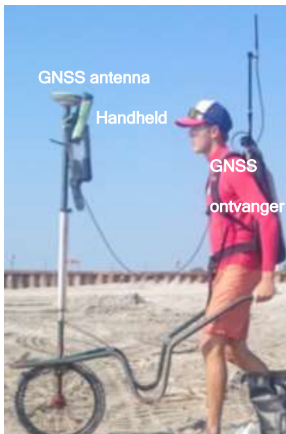
Figuur 2: GNSS rolconstructie met meetapparatuur erop.
