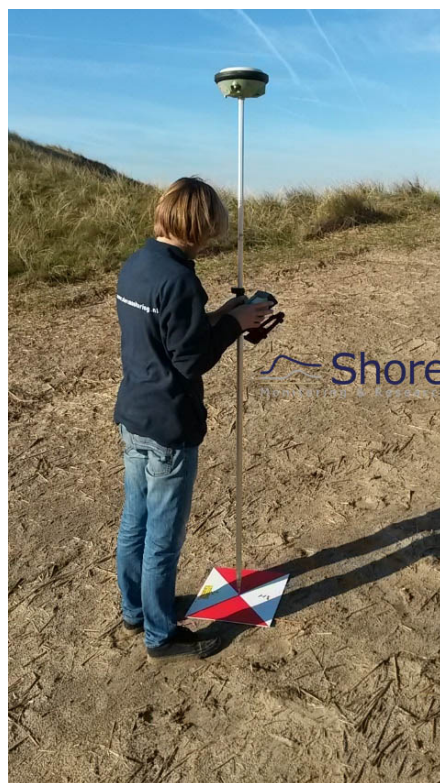
Figuur 2.1: Voorbeeld GCP en inmeten hart GCP met RTK-GNSS
