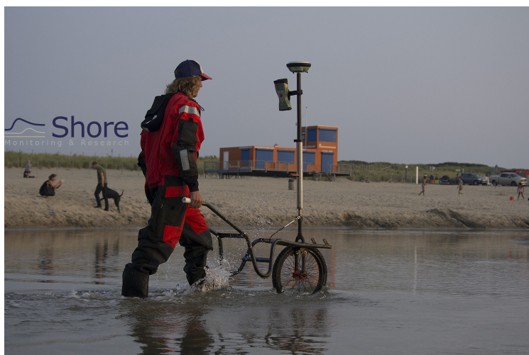
Figuur 2.3: RTK-GNSS rolconstructie
