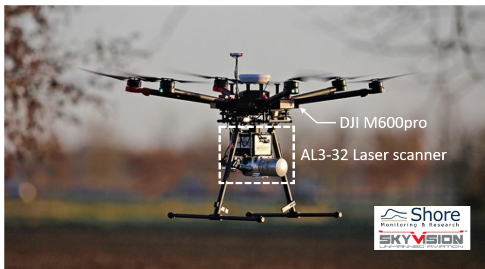
Figuur 2.2: DJI M600pro met daaronder de mobiele laserscanner uitgerust met camera
