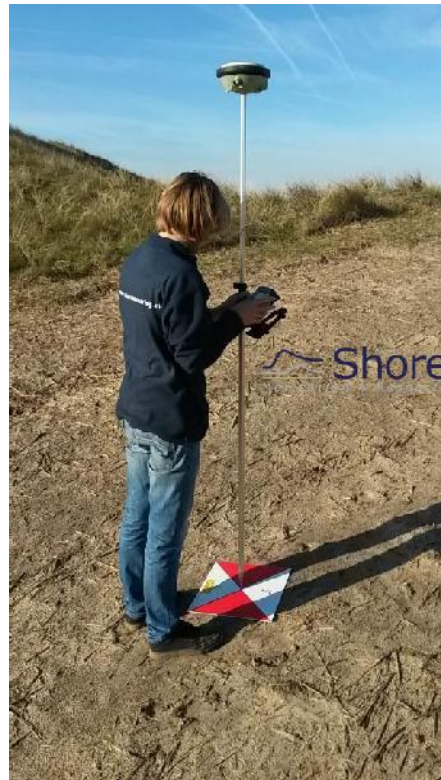
Figuur 4.4: Peilstok waarmee o.a. het hart van grond controle punten wordt ingemeten bij fotogrammetrie projecten.
