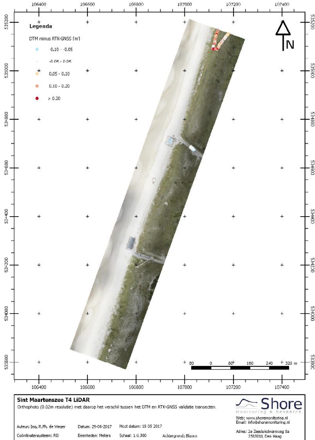
Figuur 3.7: Orthophoto Sint Maartenszee o.b.v. UAV LiDAR luchtfoto's. Hoogteverschil met validatiemetingen in kleur aangegeven.
