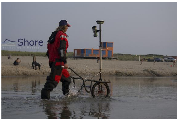
Figuur 4.3: De GNSS-carrier waarmee lopend de hoogte van het grondoppervlak gemeten kan worden.
