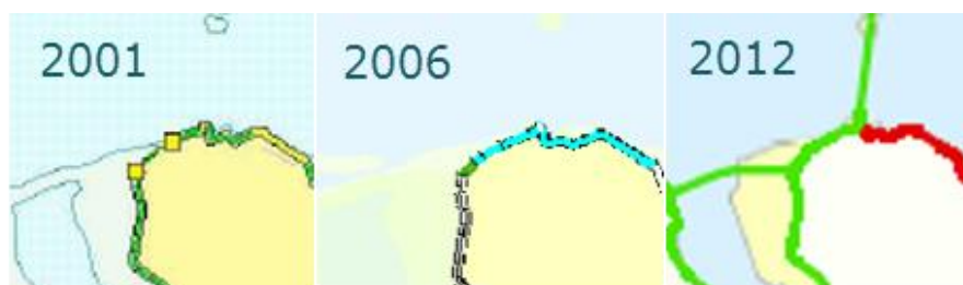
Figuur 5.7 Toetsresultaten primaire waterkering in de 1 e (2001), 2 e (2006) en 3 e (2012) toetsronde. Groen betekent goedgekeurd, geel of blauw geen oordeel of afgekeurd. Bij de laatste toetsronde is de gehele kering langs de Noordzeekust goedgekeurd.
