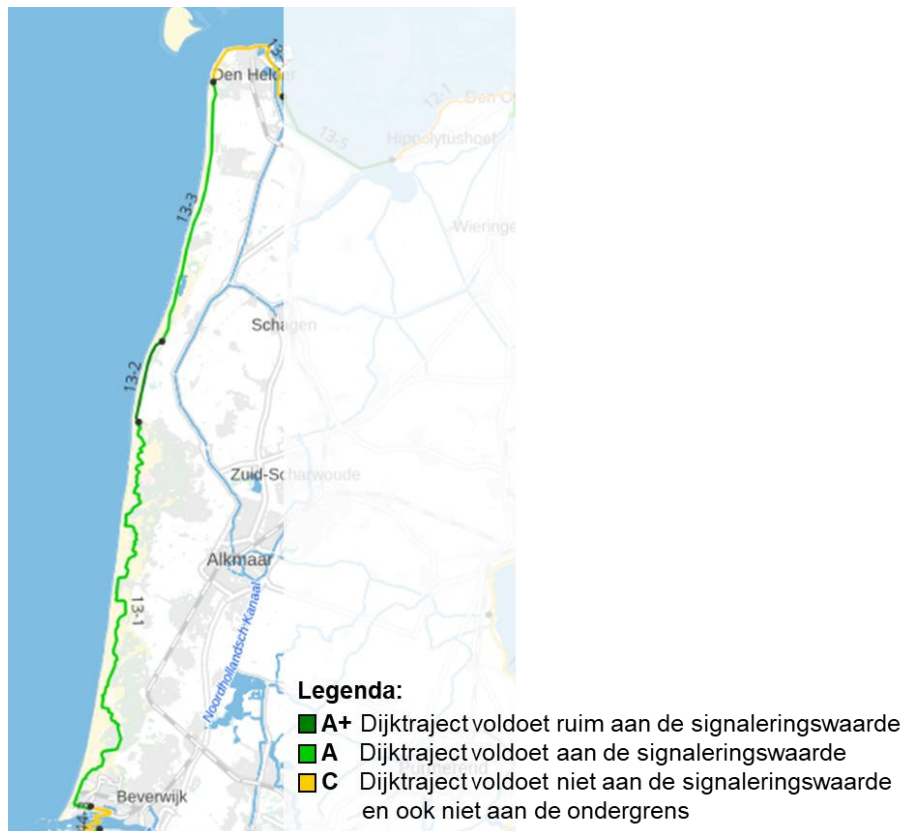
Figuur 4-4 : Actuele veiligheidsstatus van de primaire keringen voor normtraject 13-1, 13-2, 13-3 en 13-4 ( www.waterveiligheidsportaal.nl , geraadpleegd juli 2023).
