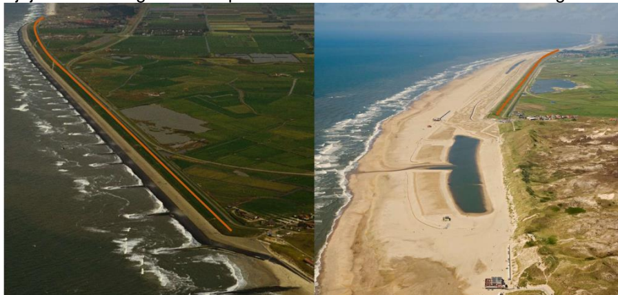
Figuur 6-9 : Links: HPZ voor de 2015-suppletie (beeldbank RWS). Rechts: de Hondsbossche Duinen net na aanleg van de suppletie in april 2015 (Aannemerscombinatie Zwakke Schakel–Van Oord-Boskalis). De rode lijn geeft de kruin van de originele zeedijk weer (bron: Kroon et al., 2022).
