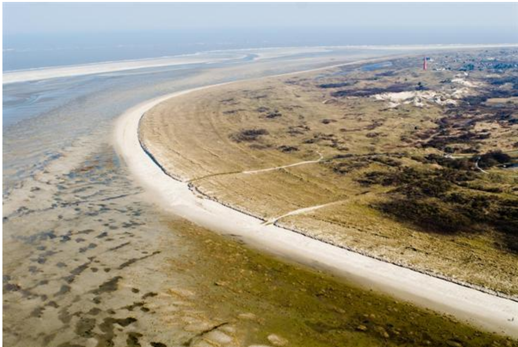
Figuur 5.4 Overzicht van de stuifdijken aan de westkant van de eilanden die ook het oude groene strand insluiten, foto 2007; https://beeldbank.rws.nl , Rijkswaterstaat
