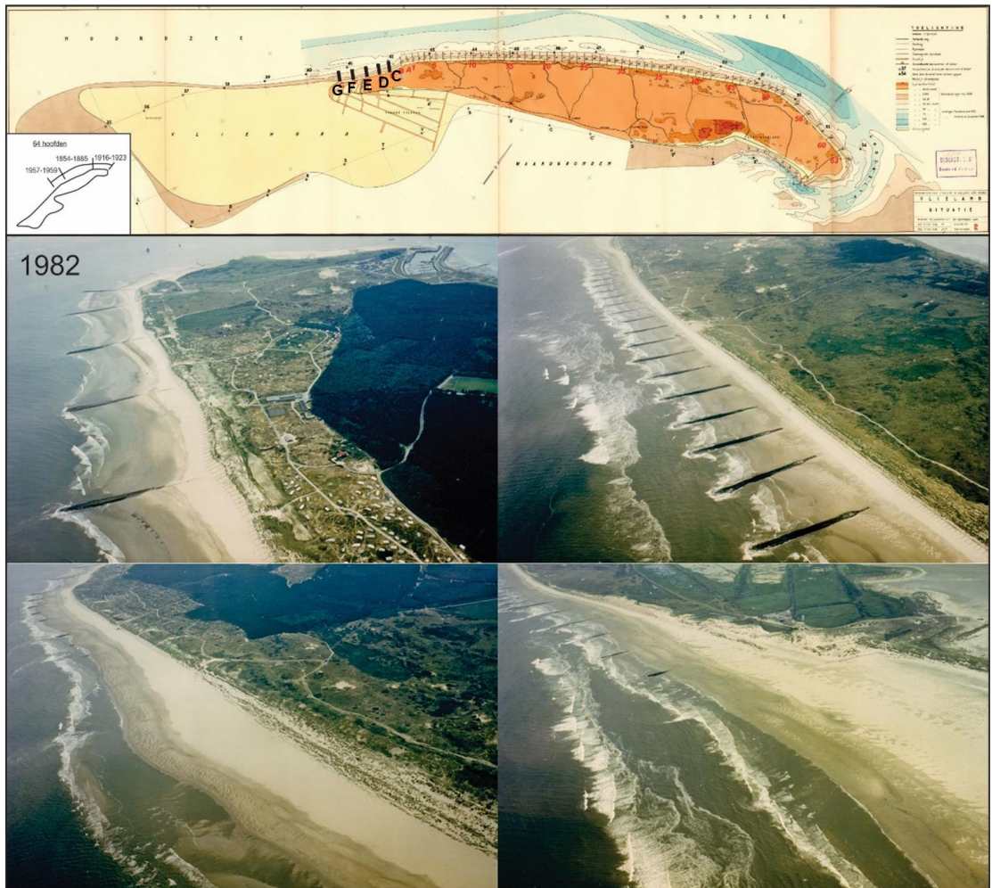
Figuur 4-2 - Boven: ligging van de strekdammen aan de hand van een kaart uit Visser (1946), met toegevoegd locatie hoofden C-G. Onder: Impressie van de strekdammen van Vlieland nabij de NO punt (linksboven en - onder), centrale eilandkust (rechtsboven) en overgang naar de Vliehors (rechtsonder). Foto's: https://beeldbank.rws.nl , Rijkswaterstaat.
