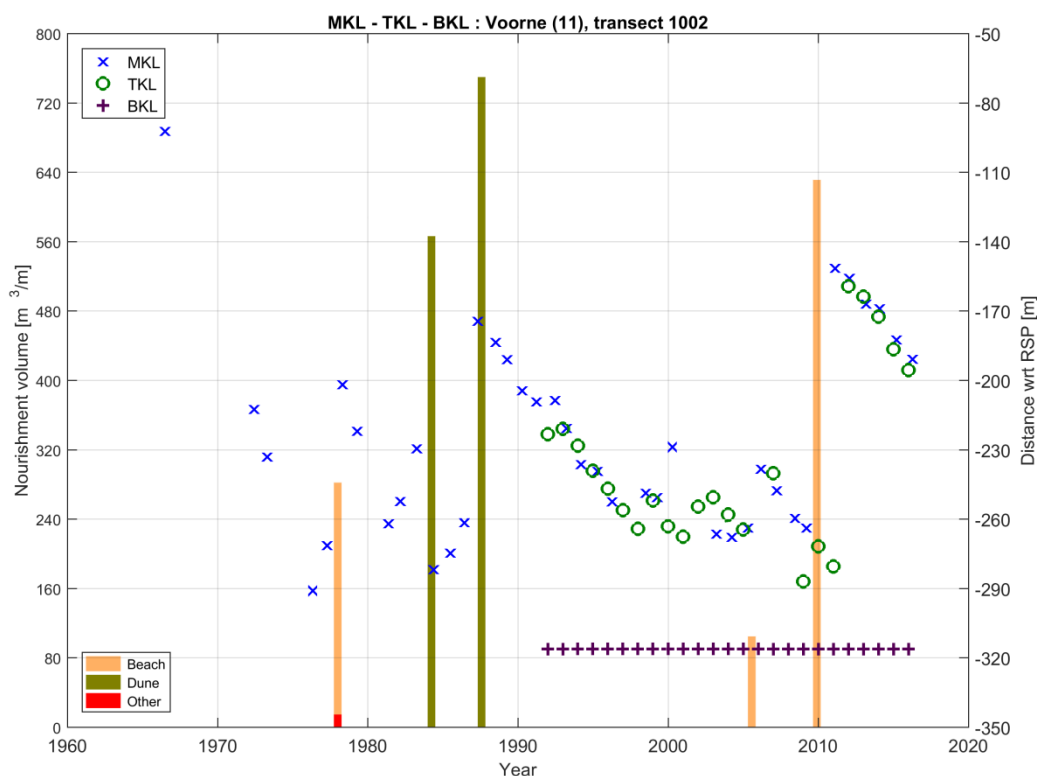
Figuur 4.17 Grafiek met de positie van de MKL, TKL en BKL voor raai 1002. De groene verticale lijnen geven de duinversterkingen weer, de oranje lijnen de strandsuppleties. De duinversterking van 2009, 2010 ontbreekt in deze figuur. De linker as geeft het volume van de uitgevoerde suppleties, in m^3/m . De rechter as geeft de afstand tot het nulpunt van de RSP-lijn.
