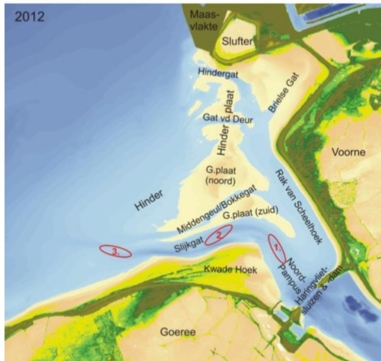
Figuur 3.15 De Monding van het Haringvliet met in rood de gebieden waar wordt gebaggerd om de vaargeul op diepte te houden: 1 Drempel bij de Pampus; 2: Drempel bij de Kwade Hoek; 3: Drempel bij de Hinderplaat (uit Arcadis, 2015)
