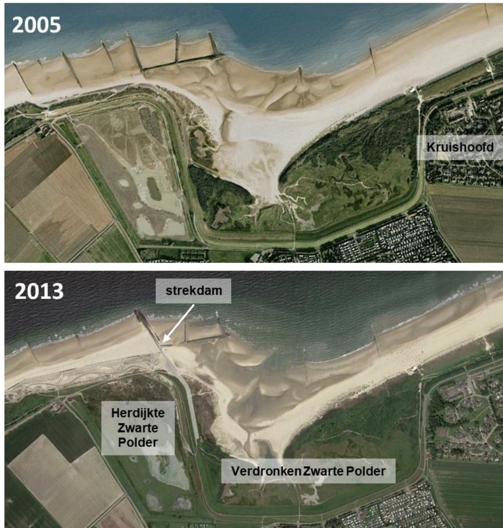
Figuur 5.8 - Kustversterking Zwakke Schakel Verdronken Zwarte Polder voor (2005) en na (2013). Bewerkt uit Google Earth afbeeldingen
