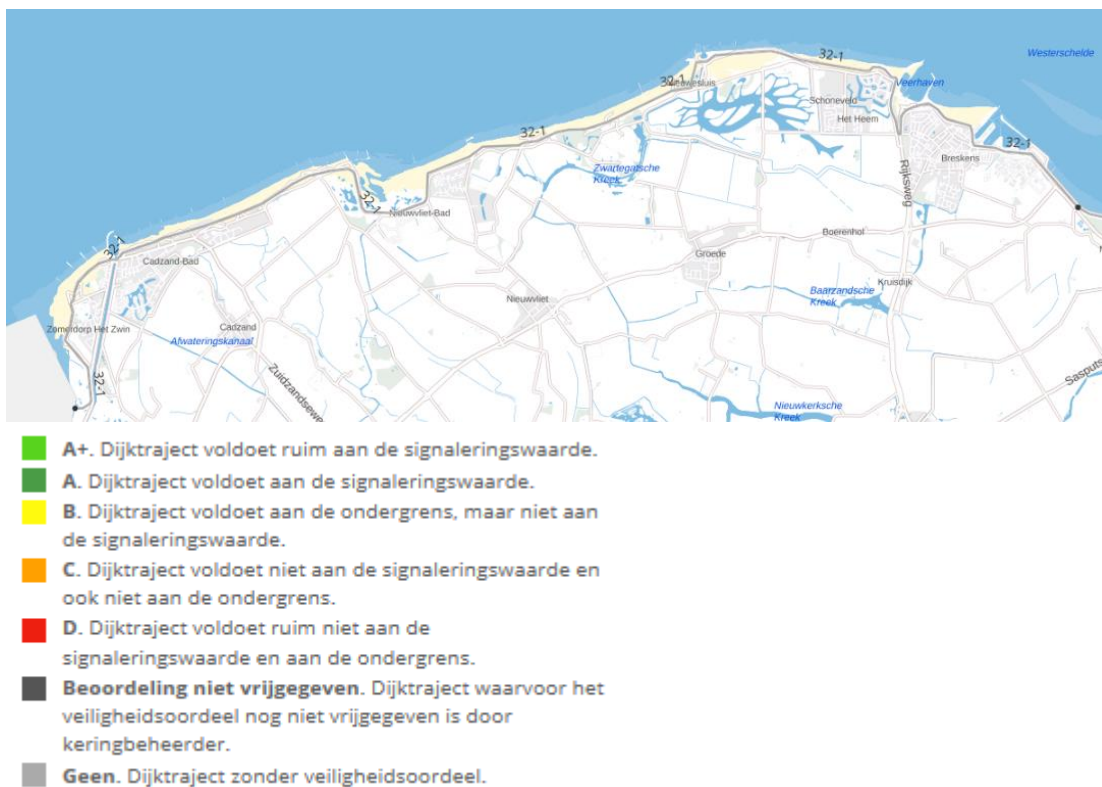
Figuur 5.10 - Het veiligheidsoordeel van de kering op trajectniveau voor Zeeuws-Vlaanderen. Bron: https://waterveiligheidsportaal.nl/#/nss/nss/assessment , bezocht op 20 november 2019
