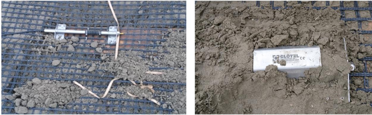
Abbildung 4.6 Installation der Wegaufnehmer am Geogitter (links: ohne Schutzhülle, rechts: mit Schutzhülle)
