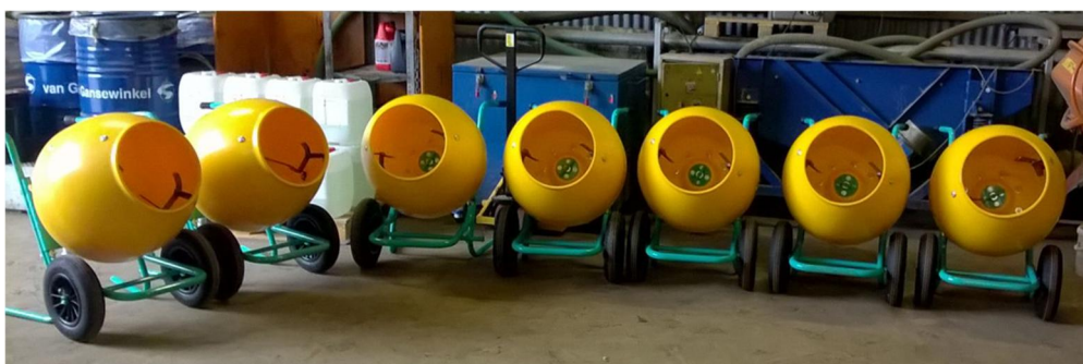
Figuur 1: Cementmolens gebruikt voor blootstellingsonderzoek asbest.
