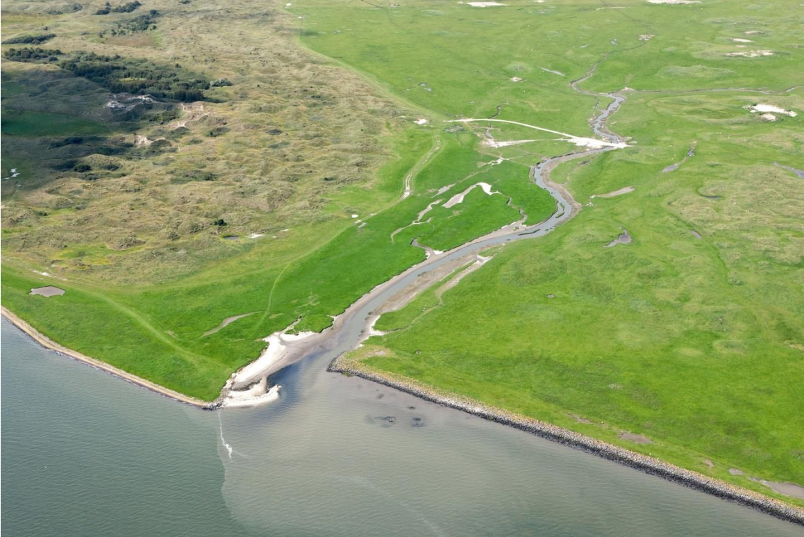
Figuur 6-12 Luchtfoto van de westzijde van de overgang van de duinen naar het Neerlands Reid, met in de voorgrond de bestorte kwelderrand en in het midden een van de kwelderkreken (bron Rijkswaterstaat/ Joop van Houdt.)
