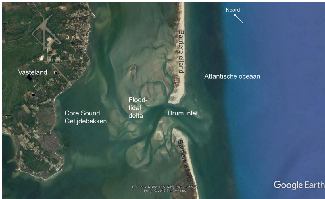
Figuur 5-2 Drum inlet aan de oostkust van de Verenigde Staten (North Carolina)
