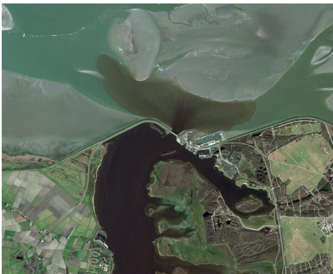
Figuur 3-5 Satellietopname van de uitstroom van zoetwater via de Clevering(a)-sluizen vanuit het Lauwersmeer naar het de Zoutkamperlaag (opname 15 februari 2019).
