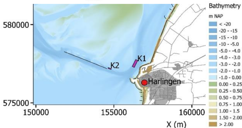
Figuur 3.13 Verspreide volumes en locaties K1 (Kimstergat) en K2 (Pollendam) van de haven van Harlingen in 1.000 m 3 /jaar. Bron: Baptist et al. 2019.
