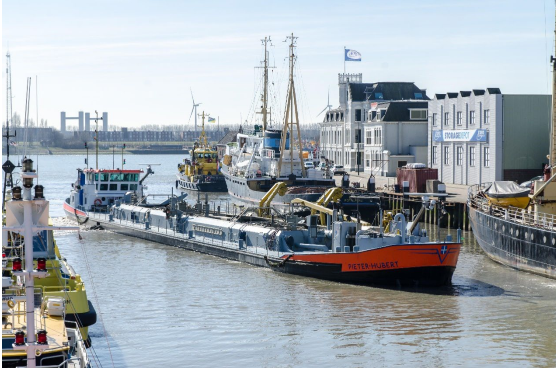
Figuur 7 Sleephopperzuiger Pieter Hubert, beunvolume 931 m 3 , enkele zuigbuis Ø550 mm, maximale zuigdiepte 25 m, 536 kW baggerpomp (Bagger- en Aannemingsmaatschappij Van der Kamp BV)
