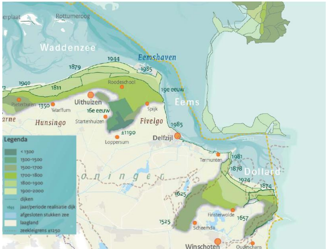
Figuur 2-4 Landaanwinningen en bedijkingen in het Eems-estuarium. Aangepast van: brochure Morfologische veranderingen RWS .
