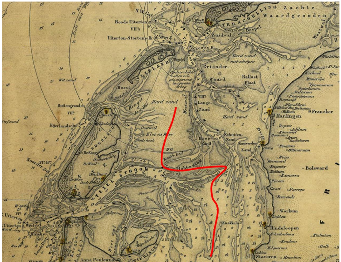
Figuur 4-4 Historische topografische kaart uit de periode 1883 (J. Swart, 1883) van de kombergingengebieden Marsdiep, Eierlandse Gat en Vlie. De rode lijn geeft het morfologische wantij aan tussen Marsdiep en Vlie gebaseerd op geulpatronen en het ondiepste punt.
