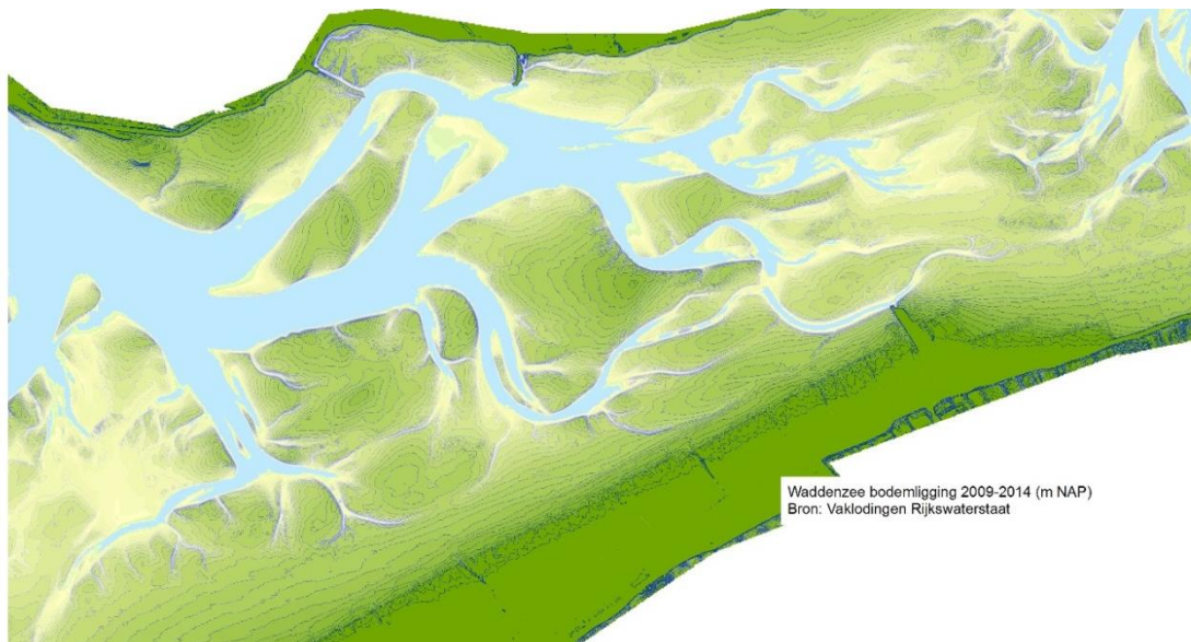
Figuur 4.4 Bodemliggingen ten zuiden van Ameland (2011), waarbij de hoogteschaal voor de platen flink is opgerekt, waardoor hoogteverschillen duidelijk zichtbaar zijn.
