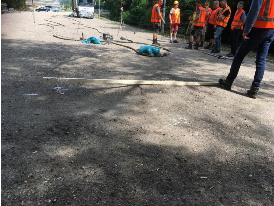
Figuur 4.17 Meting met 3 m lat op 600 mm oppersing nabij punt 329
