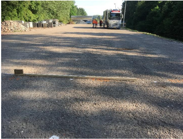
Figuur 4.4 De tonronde van 30 tot 45 mm, zoals gemeten met een 3 m lange lat
