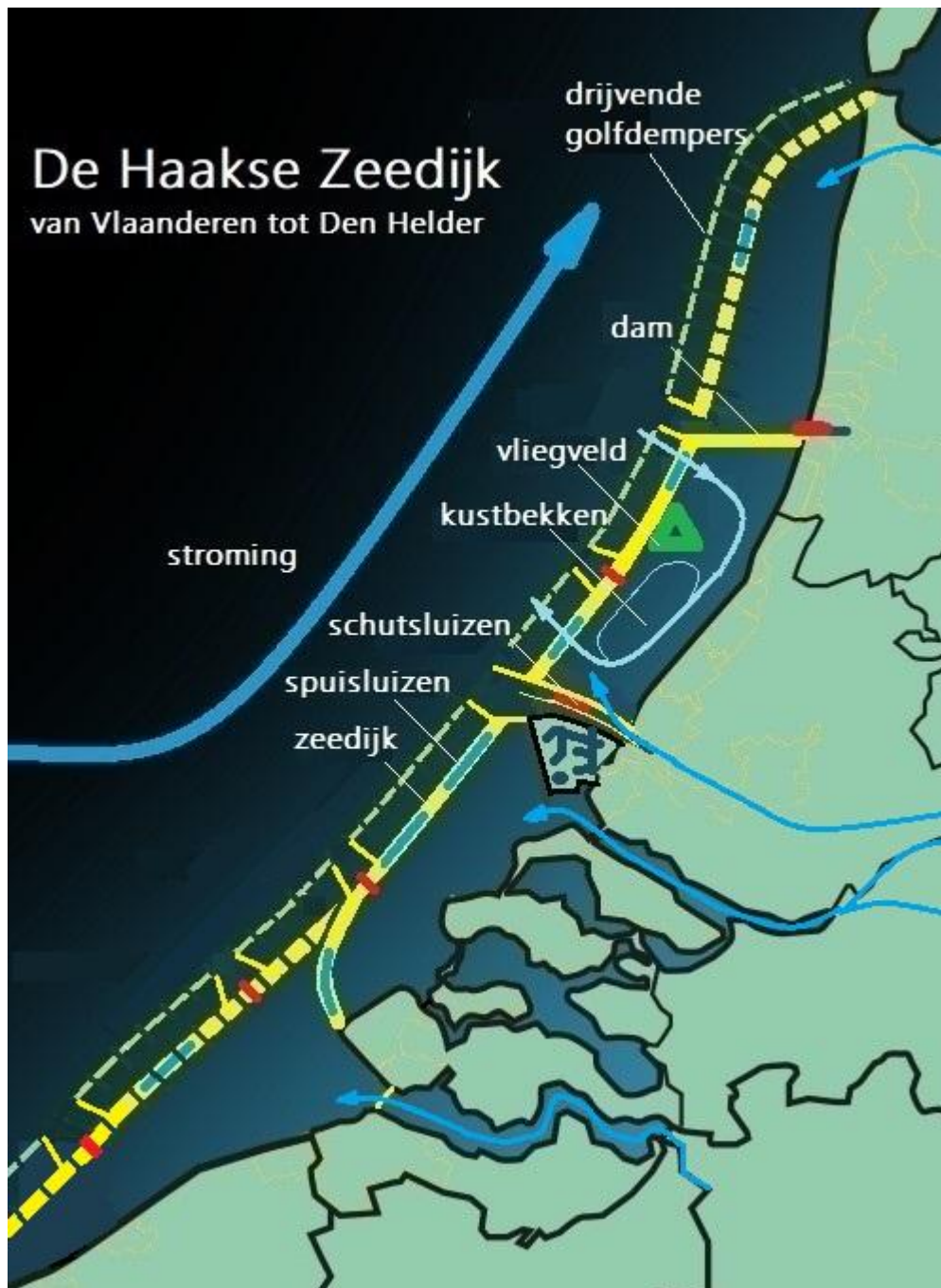
Figuur 25: Schematische weergave van een variant van De Haakse Zeedijk. Samenwerken met de ondiepe en zandige bodem van de Noordzee en de zandaanvoerende stromingen vormt de basis van deze nieuwe kustlijn. Adviesgroep Butijn & van den Haak.
